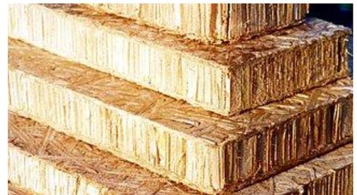
Bild: Platten aus Rohrkolben (typha technik)
